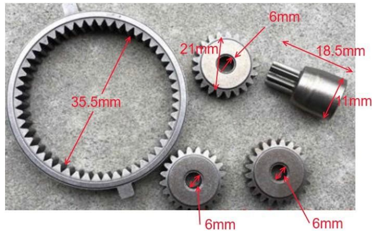
Figura 4.7 Engranaje planetario para motores brushless
