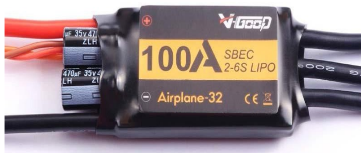
Figura 4.4 Driver ESC para motor de elevador
