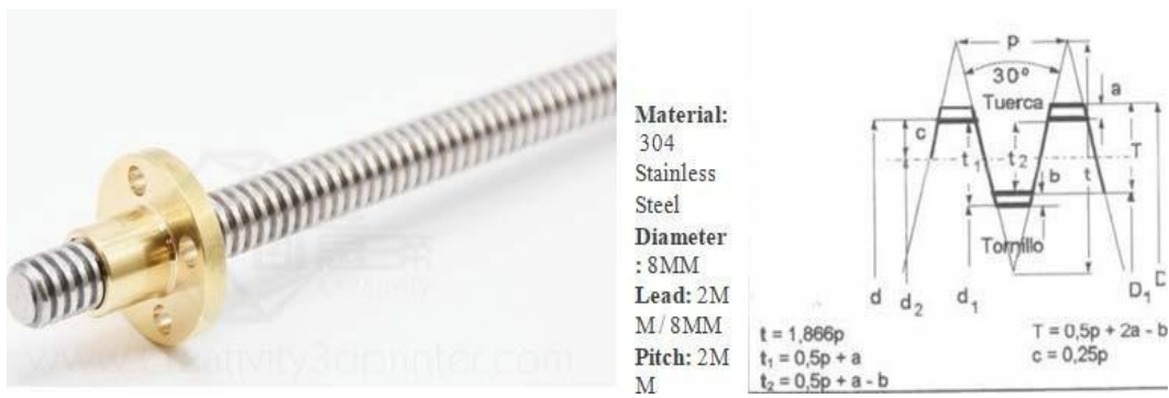
Figura 4.5 Tornillo T8 y dimensiones
