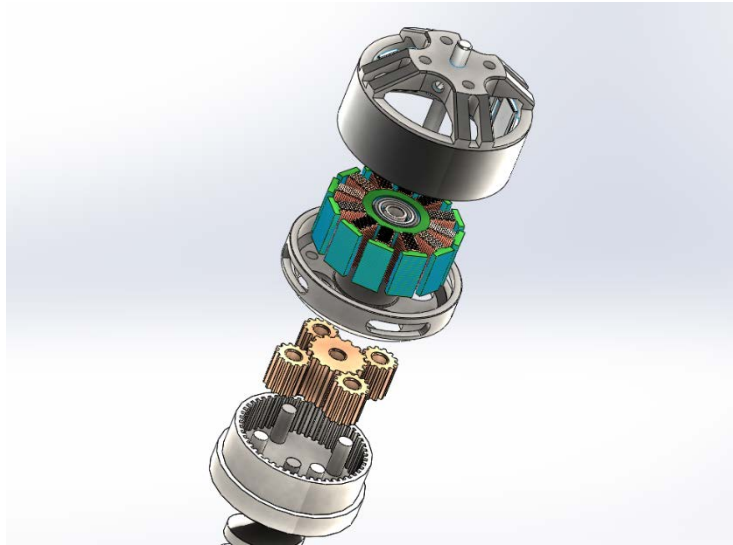
Figura 4.14 Vista desarmada del motor-elevador
