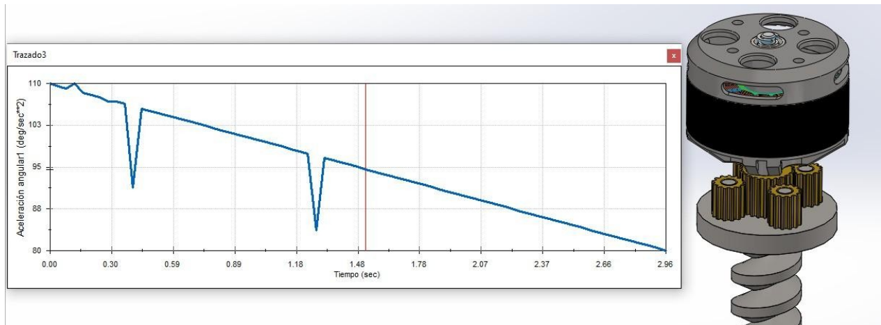
Figura 4.16 Aceleración angular en motor brushless
