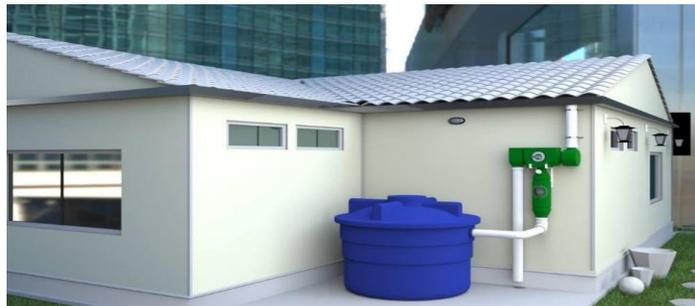
**2.2.4. Usos Actuales y Potenciales:** El uso actual del sistema de recolección de agua pluvial, es captar el agua de la lluvia para el uso doméstico, uno de sus usos potenciales es que el agua captada y con los tratamientos necesarios se convierta en agua potable, igual para el uso agrícola incluyendo vitaminas para las diferentes cosechas y así los agricultores tenga un beneficio.
