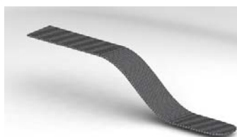
Figura 11. Placa superior en fibra de carbono para soporte de módulo piramidal y sistema de inversión y eversión
